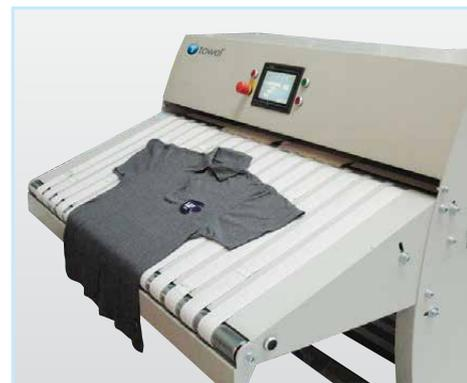
I capi sono posizionati sul nastro trasportatore di introduzione. Questo nastro trasportatore entra in funzione non appena viene rilevata la presenza del capo o dopo l'attivazione manuale con un pulsante a lato della macchina a seconda della programmazione.
