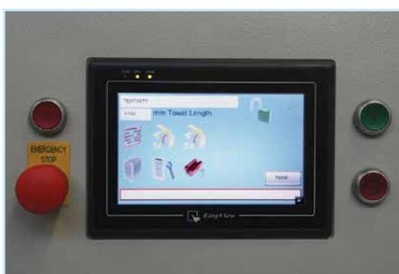
La piegaspugne **t.Towel** ha un PLC basato su controllo di sistema tramite un facile schermo touchscreen con 7 colori. Il sistema di controllo ha bisogno di un computer potente e pertanto TEXFINITY ha scelto un plc della OMRON. Questo potente processore permette di ottenere il massimo della precisione nella piegatura, testata con dei test comparativi. Grazie al touchscreen reattivo di alta risoluzione, diventa estremamente facile costruire o modificare i programmi di piegatura.
